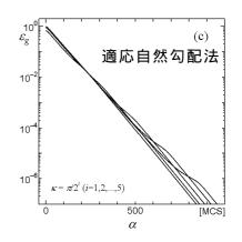
ダイナミクスを数値的に解いたところ,適応 自然勾配法は自然勾配法と同等の性能を示した. また,自然勾配法では更新スピードが速すぎる とプラトーが生ずるが,適応自然勾配法では, ネットワークパラメータの更新スピード と推 定行列の更新スピード の比が大きいと,プラ トーが生ずることが分かった.
